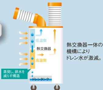
熱交換器一体の機構によりドレン水が激減。
