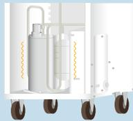
配管の形状バランスをとる事で、コンプレッサから発生する振動を抑制し、本体の負荷が少ないので長く使用でき、騒音も軽減する構造です。
